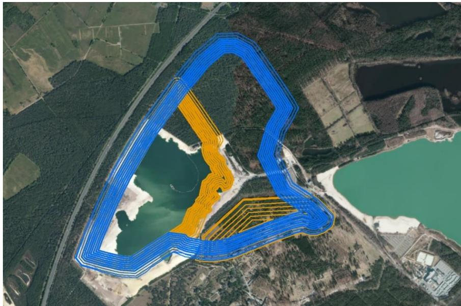
Abbildung 39: Seegeometrien Haltern-Sythen nach aktueller Genehmigungslage (orange) und gemäß aktuell beantragter Rahmenbetriebsplanerweiterung (blau)
