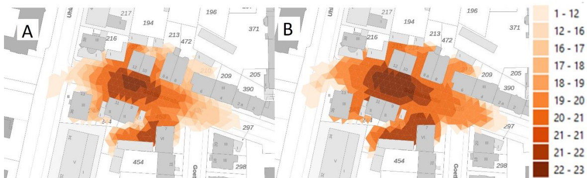
Abbildung 27: Verteilung der Einstaudauer im überfluteten Bereich für T_n = 10a (A) und T_n = 100a (B), Simulierte Zeit beträgt zwei Stunden
