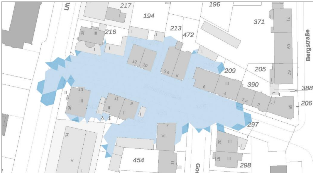
Abbildung 24: Vergleich der eingestauten Fläche (ab 30cm) für den T_n = 10a (hellblau) und T_n = 100a (dunkelblau)
