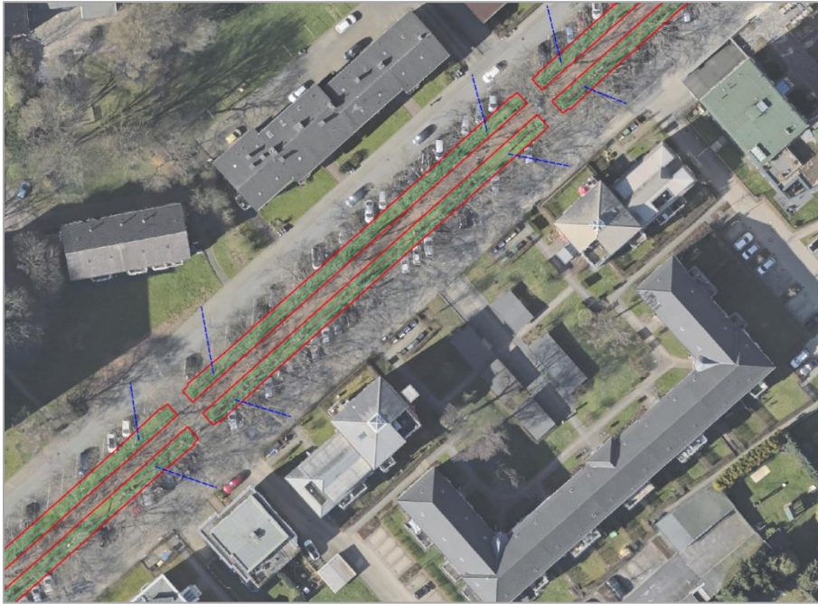
Abbildung 22: Dezentrale Mulde in rot und die vereinfachte Abbildung (negativer Puffer) der dezentralen Mulde in grün
