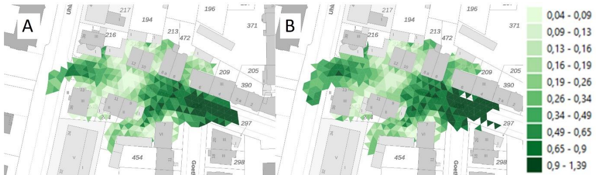
Abbildung 26: Verteilung der maximalen Fließgeschwindigkeiten im überfluteten Bereich für T_n = 10a (A) und T_n = 100a (B)
