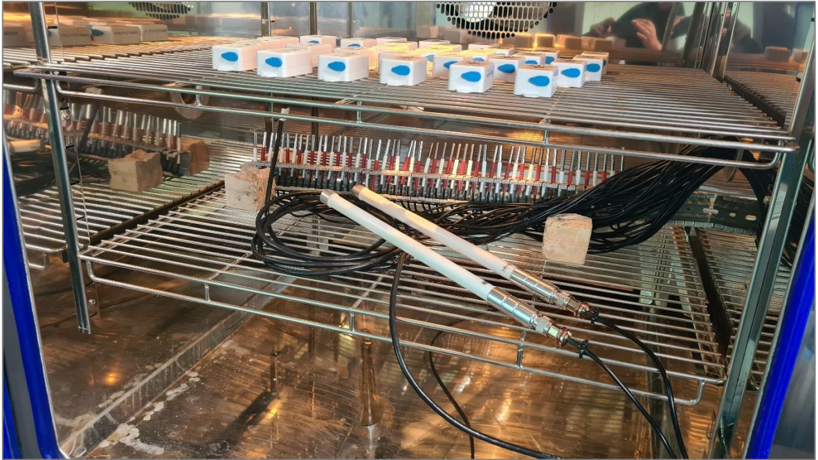
Abbildung 10: Temperaturprüfschrank des Instituts für Werkstoffkunde (IW) der Leibniz Universität Hannover (LUH) mit LoRaWAN-fähigen Dragino-Testsensoren, die im Gehäuse (obere Schiene) und außerhalb des Gehäuses (untere Schiene) messen. Die beiden geeichten Pt100-Referenzsensoren sind zwischen diesen beiden Testgruppen montiert.
