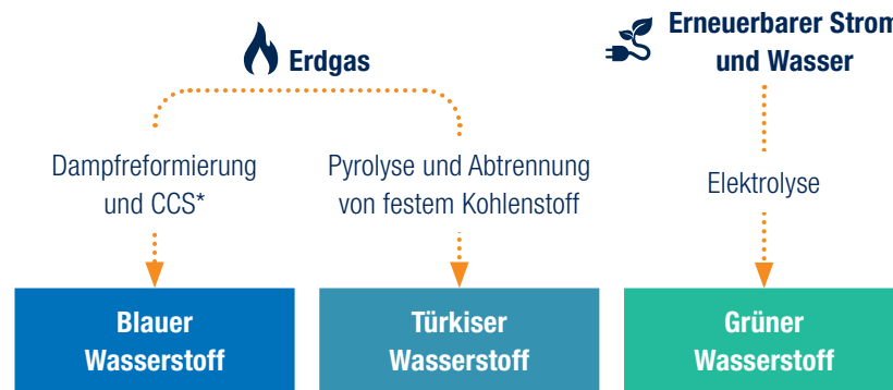
Abb. 1 Vereinfachte Darstellung der Erzeugungsverfahren von Wasserstoff
