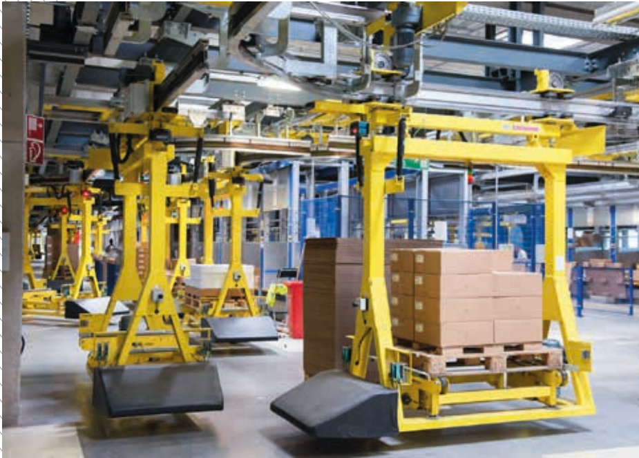
Wie von Geisterhand bewegen sich die Fahrzeuge der Einschienenhängebahn im IKEA Distributionszentrum Dortmund-Ellinghausen.
