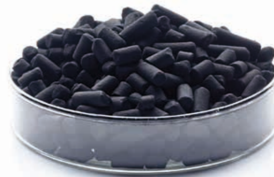
Das Essener Unternehmen CarboTech AC setzt Aktivkohle für die Luft- und Gasreinigung sowie zur Wasser- und Flüssigkeitsbehandlung ein.
